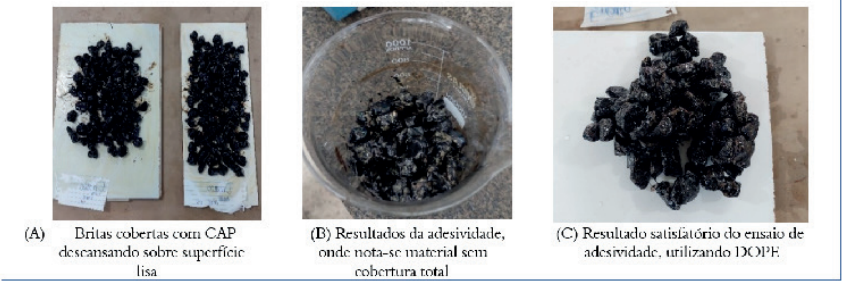
Figura 4: Resultados dos ensaios de adesividade sem, e com adição de DOPE, (2023)
