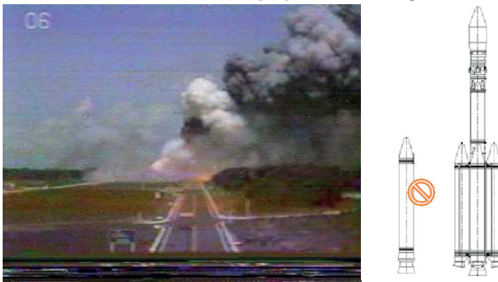
Figura 1 - Registro da imagem tomada pela câmera 6, localizada sobre o Prédio de Preparação de Propulsores (PPP), ao lado o esboço do VLS-1 V03, indicando a falha no propulsor do 1º estágio
