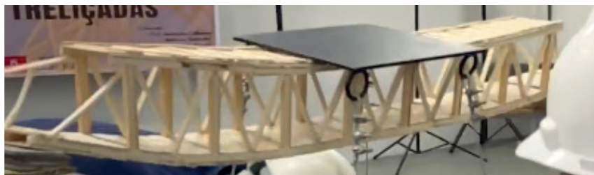
Figura 12: Autores, Imagem da ruptura da ponte (2025)
