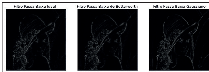
Figura 65 (b) - Resultado de filtrações Passa-Alta no domínio da frequência, através dos filtros: Ideal, Butterworth e Gaussiano. Observe o realce das bordas, característico de filtros de aguçamento, que são similares à filtros de passa alta, mas em tempo discreto.
