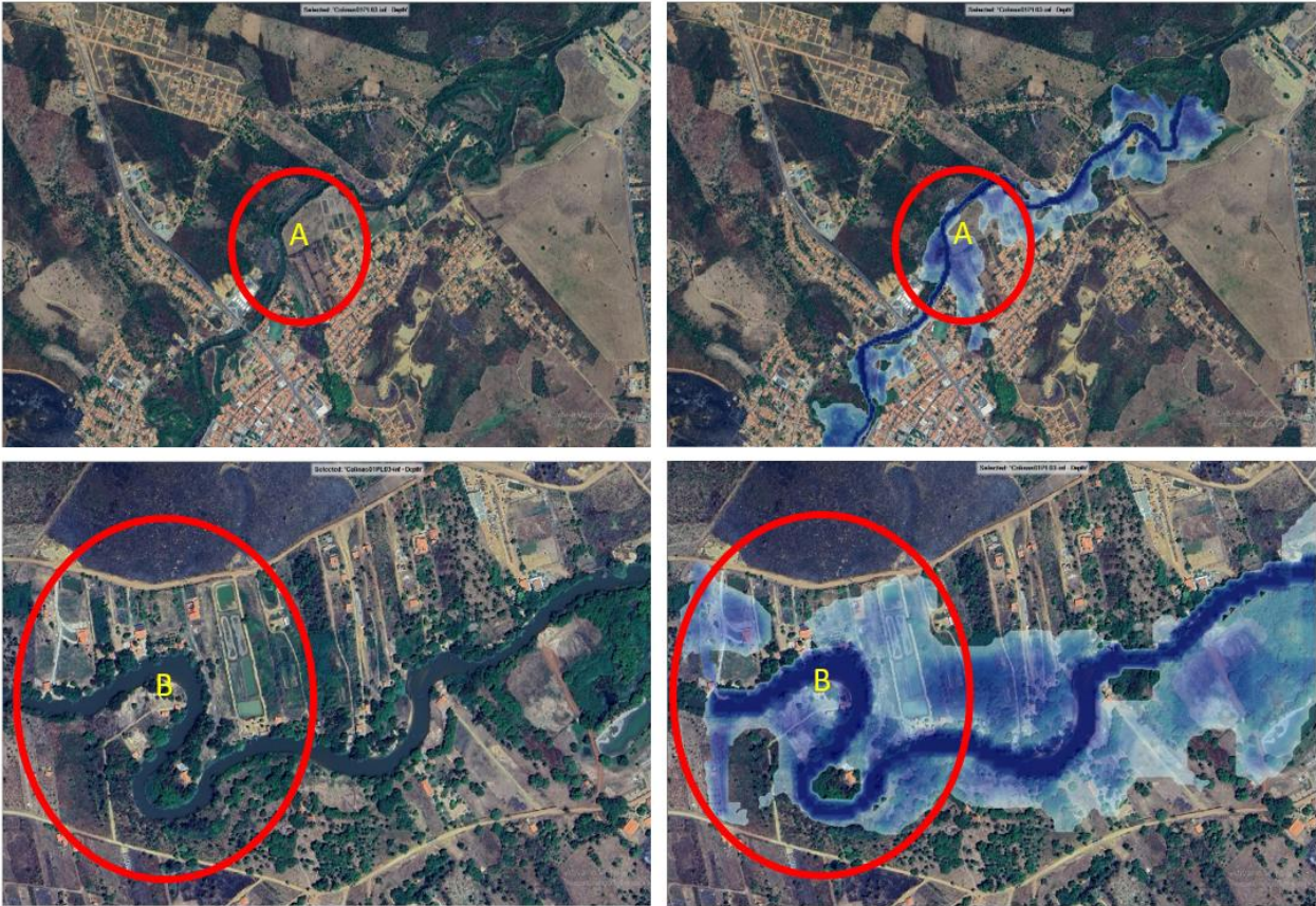
Figura 15 – Detalhe da área urbana atingida pela mancha de inundação modelada nas datas de maior cota registrada em 03/05/1985 para Colinas.
