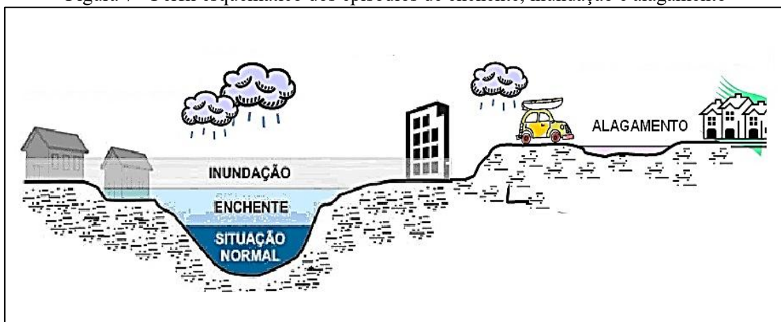
Figura 7 - Perfil esquemático dos episódios de enchente, inundação e alagamento
