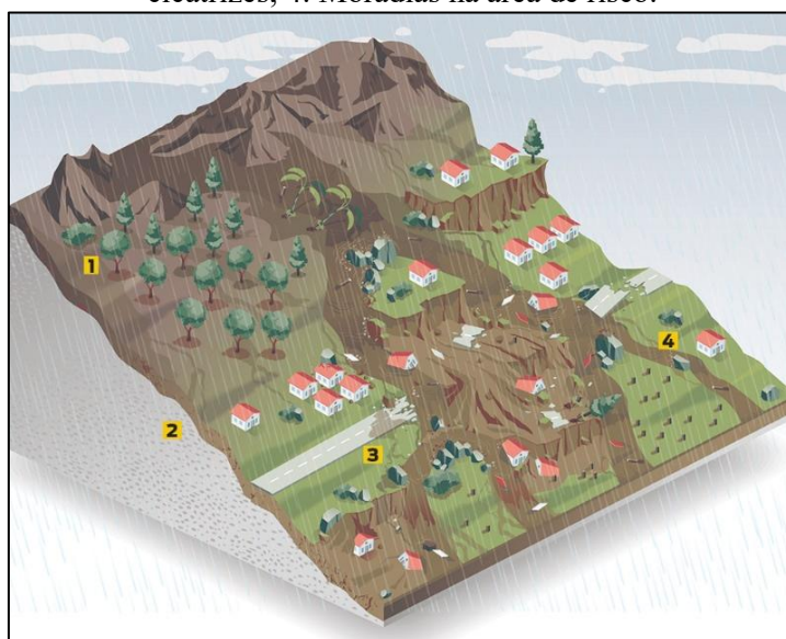
Figura 3: Imagem ilustrativa de movimento de massa em área urbana, onde 1: Área vegetada protegida do movimento; 2: Área de solo compactado; 3: Caminhos do deslizamento, formando cicatrizes; 4: Moradias na área de risco.
