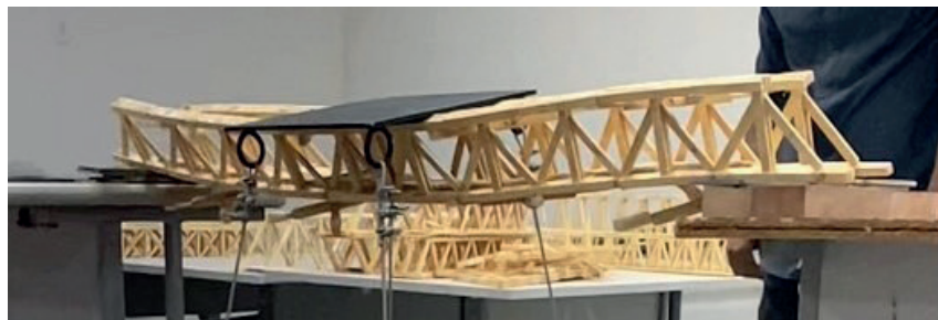
Figura 13: Autores, Imagem do momento da ruptura da ponte (2025)
