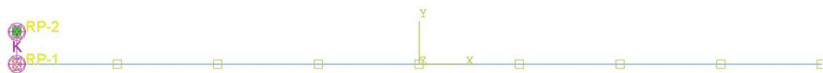
Figura 3: Autor, Modelo de viga simplesmente apoiada com massa suspensa em movimento no Abaqus (2025)
