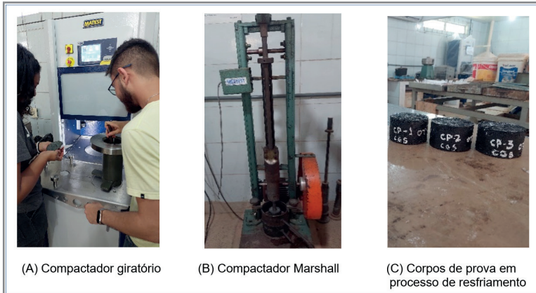
Figura 2: Autor próprio, Imagens dos compactadores utilizados no ensaio, e corpos de prova, (2023)
