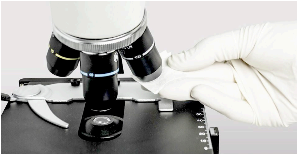
Figura 4. Procedimento de limpeza de microscópio.
