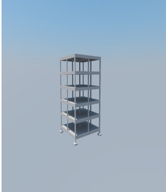
Imagem 16: Continuidade dos pilares da estrutura
