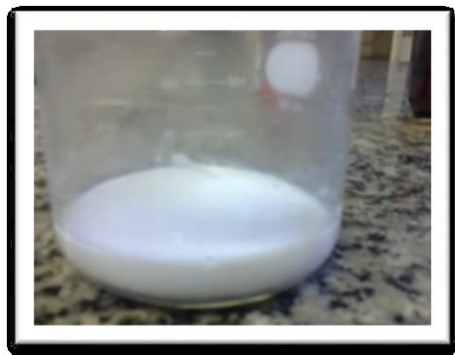
Figura 1. Dissolução do poliestireno do copo descartável em Éter Etílico Síntese do Poliestireno Expandido (EPS) para 20 g de copo descartável
