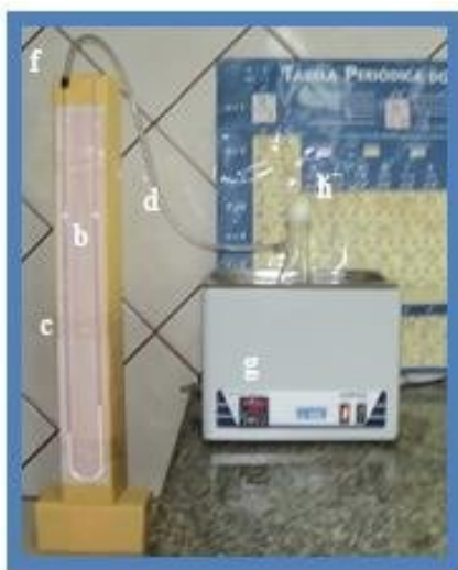
Figura 1. Sistema experimental: (a) suporte de isopor; (b) papel milimetrado; (c) tubo de vidro em U; (d) tubo de plástico; (e) conexão tubo de plástico/kitassato; (f) conexão tubo de vidro/ tubo de plástico; (g) termômetro; (h) ovo.
