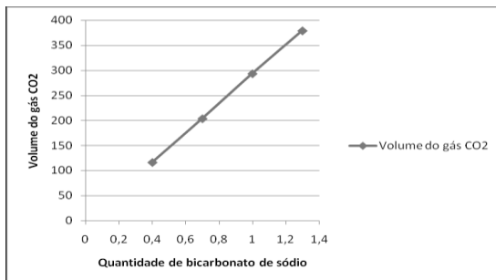
Figura 1. Quantidade de gás carbônico (CO 2 ) liberado na reação obtido com volume constante de vinagre (ácido acético), 10 mL, e quantidades variadas de bicarbonato de sódio.
