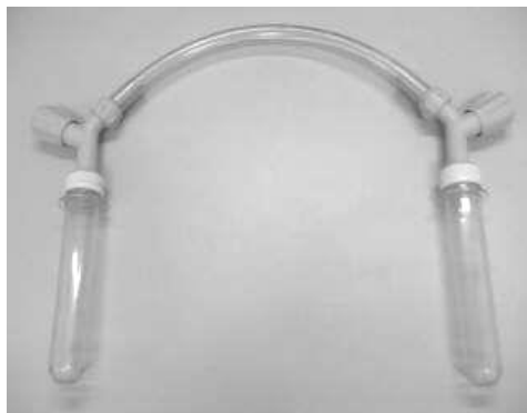
Figura 2. Sistema desenvolvido para estudo de difusão dos gases.
