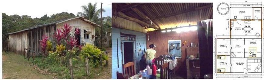
Figura 8. Moradia pré-fabricada de madeira no Povoado 410, Buriticupu. Vista frontal da casa com anexo lateral em madeira aparelhada, cozinha em taipa de mão e planta baixa do imóvel.
