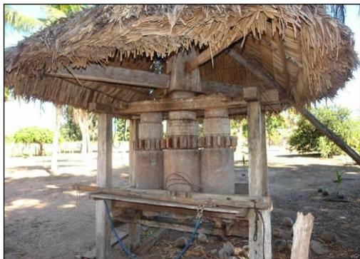
Figura 10 – Moenda de cana artesanal em madeira, coberta com fibra de Buri; ela é movida à tração animal (bois amansados); o caldo da cana é depois transformado em melado e principalmente em rapadura, em
