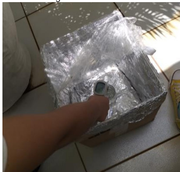
Figura 16 - Grupo A medindo temperatura da água dentro da caixa
