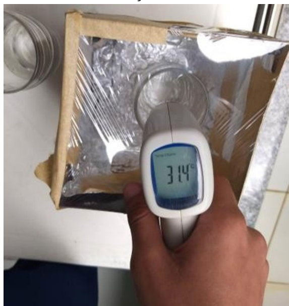
Figura 20 - Grupo B medindo temperatura da água de dentro da caixa após 30 minutos de radiação solar
