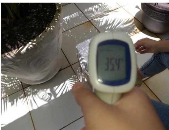
Figura 18 - Temperatura da água na caixa após 30 minutos de exposição à luz solar conferida pelo grupo A
